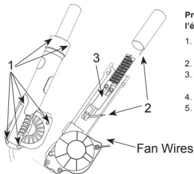
**Précaution : Déconnectez l'alimentation avant de remplacer l'élément chauffant.**
